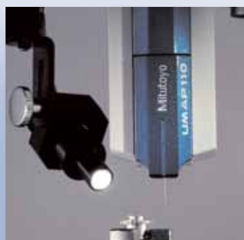
Vysoce přesné měření výšky díky automatickému zaostřování obrazu
