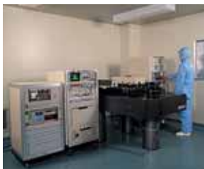
He-Ne laser (633 nm), stabilizovaný pomocí saturované absorpce v parách jodu, pro měření délky
