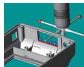
Funkce kontrola kolize odstraňuje problémy způsobené kolizí sondy nebo objektivu s obrobkem.
